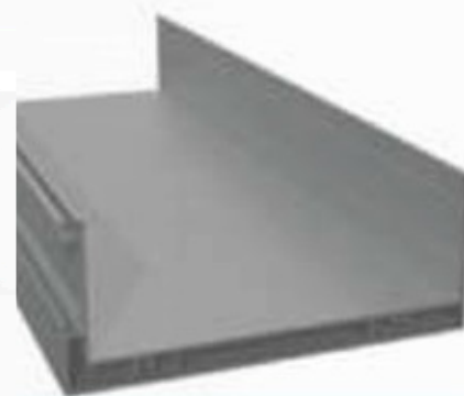
Profil rynny/Gutter profile/ Rinnenprofil W=3,434kg/m (75x195x2mm)
